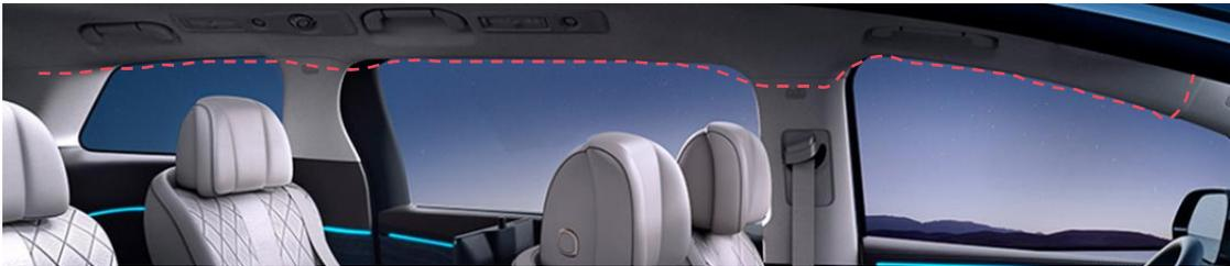
d、车内走线，线束由左后窗的位置穿出，沿着侧面车窗密封条和顶部装饰板与侧面装饰板的拼接缝隙，走线至前挡风玻璃左边框处。
