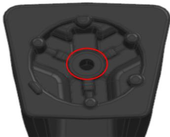
a、用十字螺丝刀拆下原车固定螺丝与底座，将其固定至流媒体后视镜的安装支架上;将流媒体后视镜的安装支架组装完全。
