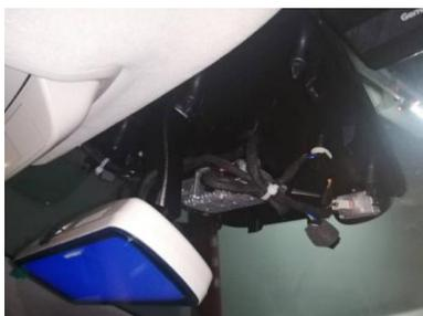
b、手握流媒体后视镜安装支架，对准安装位顺时针旋转，安装好流媒体后视镜。
