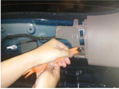
a、用翘板撬出侧面装饰盖固定螺钉，扣下侧面装饰盖板。
