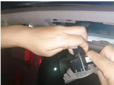
b、手持接头拔下开关线束，将开关控制器放置一边并保管好。
