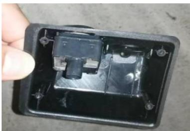
a、拿出安装的摄像头组件，将原车摄像头固定于对应位置，并将摄像头组件组装完全，将其固定于后备箱外开关装饰条对应位置。
