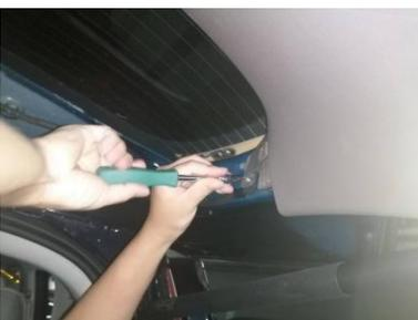
a、用十字螺丝刀拆下装饰盖两侧固定螺丝，并整理保管。
