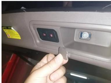
a、用翘板撬开螺栓盖，并用套筒扳手拆掉螺栓。
