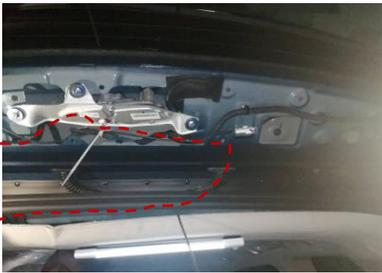
c、后备箱与车顶结合处，线束须穿过右侧线束管进入车顶装饰板里面；再沿后备箱密封条走线至车体左侧。
