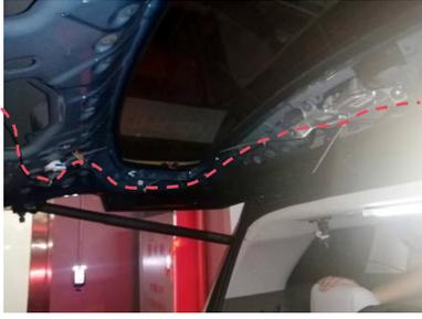
a、摄像头线束穿过后后备箱架与延长线连接，并用扎带固定于合适位置。
