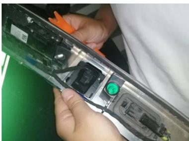
b、拔下原车摄像头线束，扣下后视镜摄像头组件。
