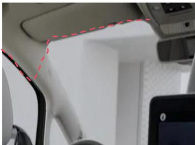
e、前挡风玻璃左侧线束，沿挡风玻璃与顶部装饰板拼接缝隙走线，直至后视镜装饰盖里。
