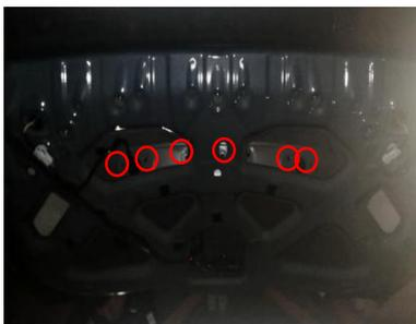
a、用套筒扳手拆下装饰条固定螺母，整理保管好。
